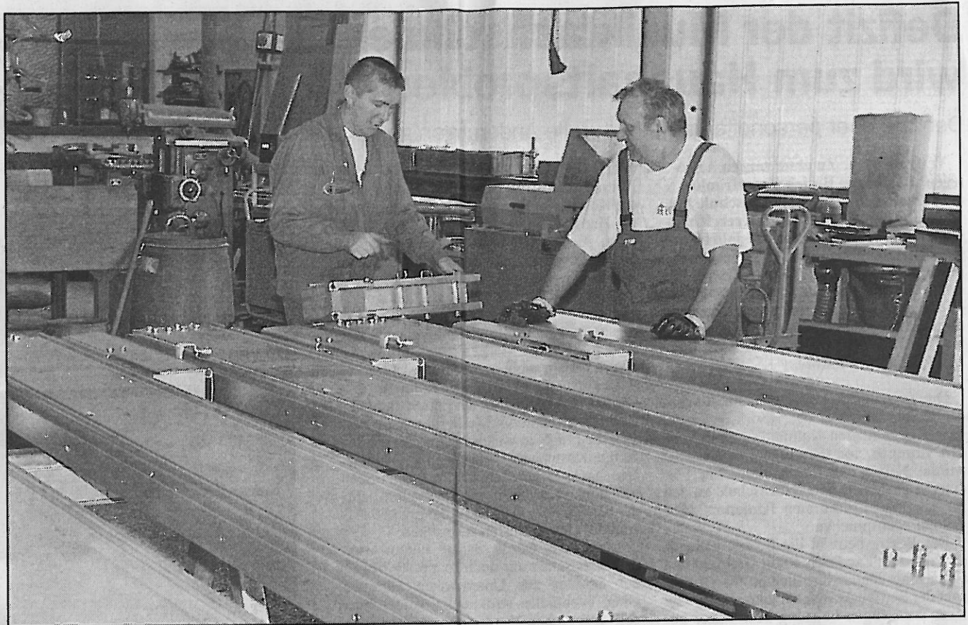
ALUMINIUMPROFILSPARREN werden in der Produktionshalle der Firma Tartler in Haingrund für die Endmontage vorbereitet. Sie gehören zu den von dem Odenwälder Unternehmen entwickelten Großzelten. Foto: Wolfgang Kraft
